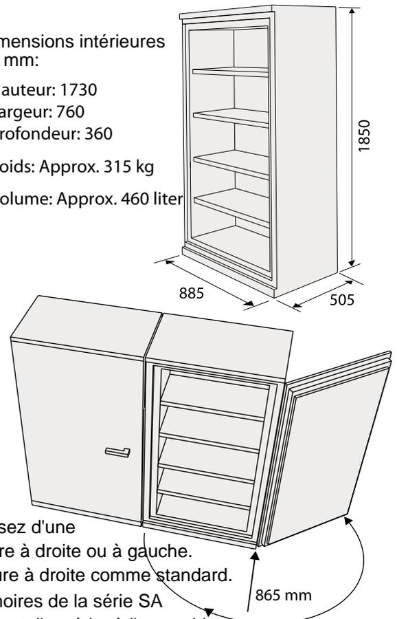
Choisissez d'une ouverture à droite ou à gauche. Ouverture à droite comme standard. Les armoires de la série SA permettent d'accéder à l'ensemble des documents par une ouverture des portes à 90° et donc de placer les armoires côte à côte.
