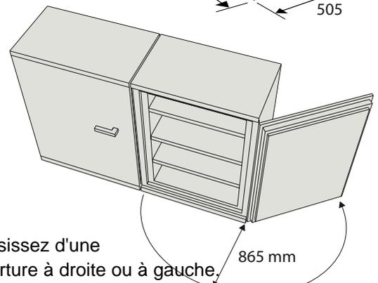
Choisissez d'une ouverture à droite ou à gauche. Ouverture à droite comme standard. Les armoires de la série SA permettent d'accéder à l'ensemble des documents par une ouverture des portes à 90° et donc de placer les armoires côte à côte.
