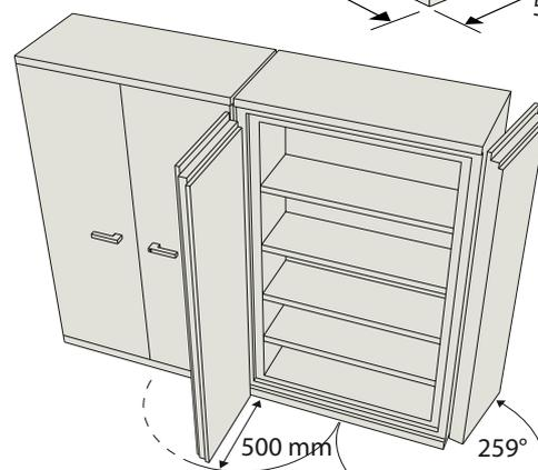
Les armoires de la série SA permettent d'accéder à l'ensemble des documents par une ouverture des portes à 90° et donc de placer les armoires côte à côte.
