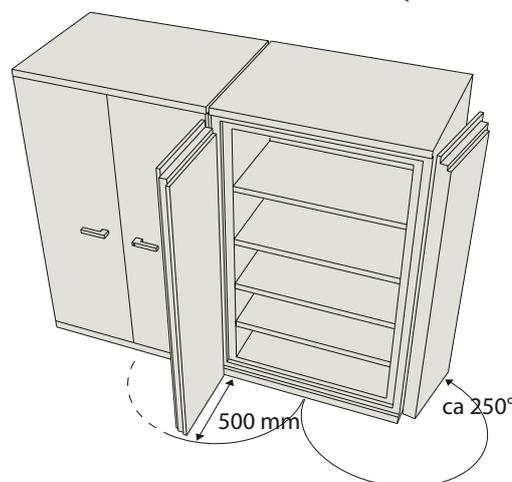
Les armoires de la série SA permettent d'accéder à l'ensemble des documents par une ouverture des portes à 90° et donc de placer les armoires côte à côte.
